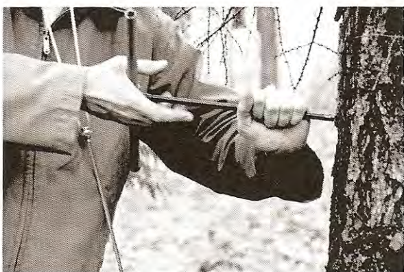
Рис. 6. Отбор образца древесины с помощью бурава Пресслера
